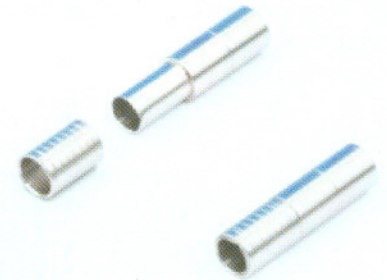
Abbildung 7 Vom Autor entwickelte zusammensteckbare Röntgenreferenzröhrchen aus Titan.
