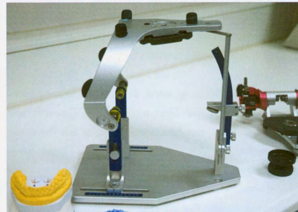
Abb. 11: Die Bissgabel kann am Montagetisch fixiert werden.
