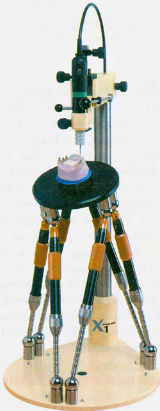
Abb. 14: Mit dem manuellen Positionierer X1med3D werden die Implantatpositionen korrekt in die Schablone übertragen.
