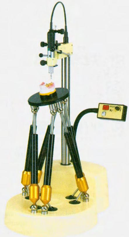
Abb. 15: Eine Arbeitserleichterung bringt die Anbindung des X2med3D an den Computer. Softwaregesteuert fährt das Gerät die Positionen selbständig und genau an.
