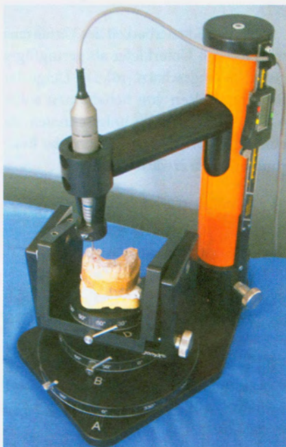
Abb. 2 ▲ Nach der 3-D-Planung befindet sich die Röntgenschablone wieder auf dem Präzisionstisch, die unterschiedlichen Koordinaten der virtuellen Implantatplanungen werden eingegeben. Danach Anlage der Bohrungen für jede Implantatposition, die durch die Koordinaten der virtuellen Planung vorgegeben werden
