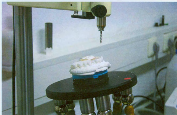
Abb. 8: Positionierer für die Überführung der Röntgenschablone in die Operationsschablone.
